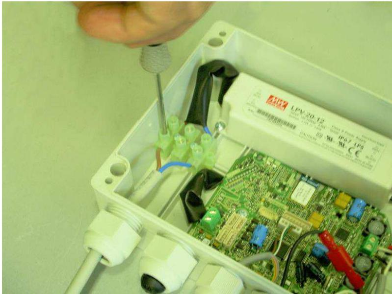
Effettuare il collegamento alla rete elettrica (assicurarsi che non vi sia corrente nell' impianto durante le operazioni di installazione).
