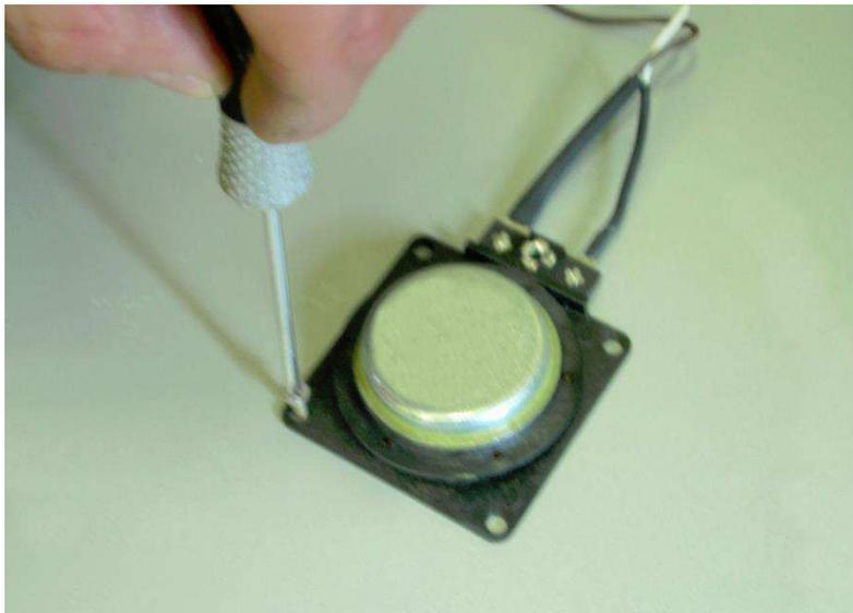
Posizionare le casse con la membrana a contatto con il controsoffitto o la parete e fissarle con nastro biadesivo o con viti autofilettanti.
